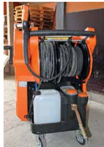
↑ Stihlissä on hyvä kela sekä letkulle että johdolle. Kaikissa pesureissa tilanne ei ollut yhtä hyvä.
