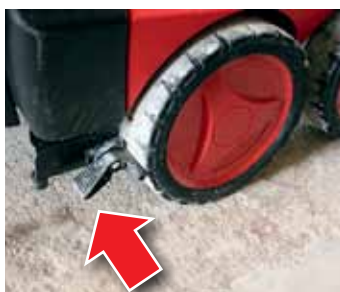
↑ Kunnollinen seisontajarru on tarpeen, sillä kuumavesipesurit ovat painavia. Clenin seisontajarru oli esimerkiksi toteutettu.
