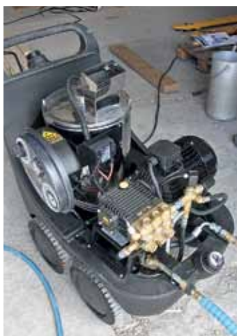
↑ Pesurin kuoren alle piiloutuu pumppu sähkömoottoreineen sekä öljypoltin ja lämmönvaihdin. Kuvassa Maerin kuumavesipesuri.
