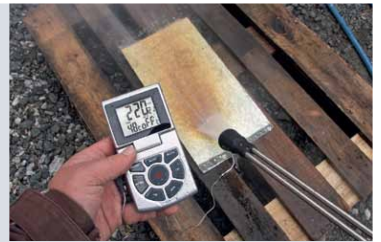
↑ Veden lämpötila pestävässä kohteessa mitattiin kuormalavaan kiinnitetyn peltilevyn avulla. Kuumalla vedellä pesulla on vaikutuksena pestävään pintaan. Kuvan galvanoitu pelti rusketui testin aikana melkoisesti. Koneiden maalipintaa pestessä kannattaa siis pitää maltiä mukana.
