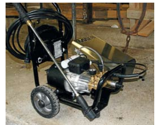
↑ Rakenteeltaan Maeria yksinkertaisempaa pesuria saa hakea. Rosterikuoren alla on suojattu moottori ja aksiaalipumppu. Painemittariin on jätetty näkymättömiin suojakannen alle.
