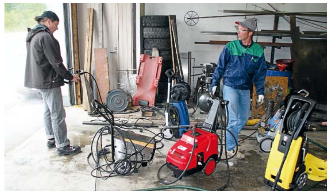
↑ Paineet ja tuotot mitattiin kaikista pesureista peräjälkeen. Verstaassa oli välillä ahdasta.
