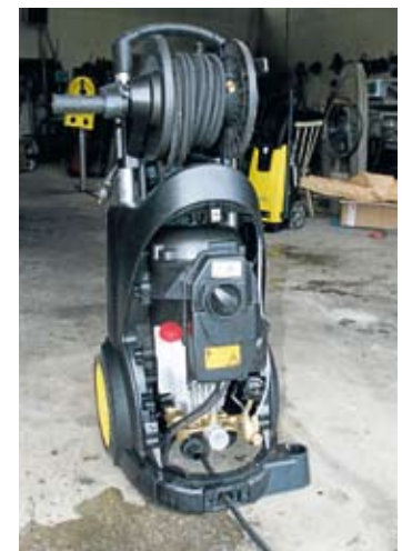
↑ Kärcher on ulkokuoren altakin selkeä paketti. Öljymäärän tarkistus ja öljyn täyttö käy helposti. Painemittariin sen sijaan kappasi lisää kokoa.
