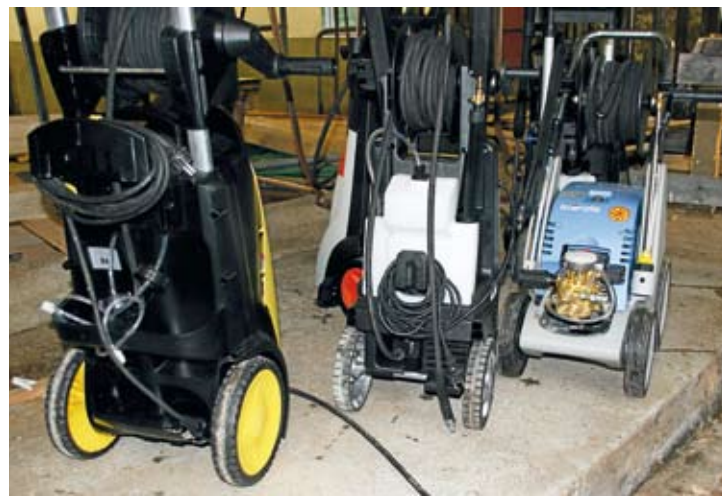
↑ Kärcherissä (vas.) on takana paikka kahdelle pesuainepullolle. Kränzlessä (oik.) pesuaine imetään suoraan pumppuun ulkoisesta pullosta tai säiliöstä. Lavor (kesk.) edustaa tyypillisintä ratkaisua: yksiosainen säiliö on koneen takana.
