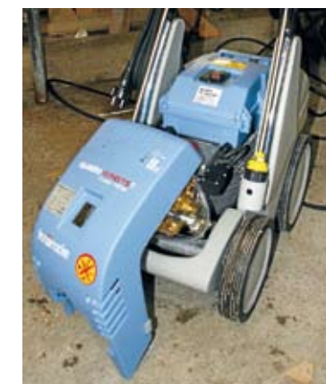
↑ Kränzle on suojattu mallikkaasti roiskeilta. Kannen alla on tiivis sähkömoottorin suojaus ja virtakytkin on hyvin muovisuojassa.
