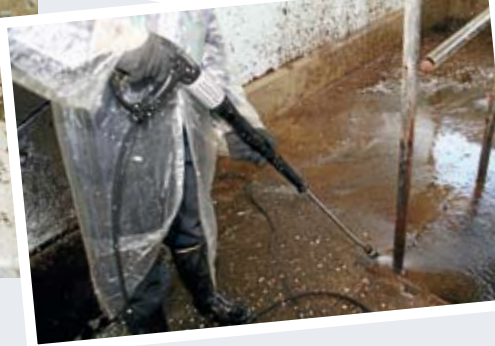
↑ Kärcherin pesupistooli oli testin paras. Riittävän pitkä ja käännettävä pesuputki helpottaa hankalien paikkojen pesua.
